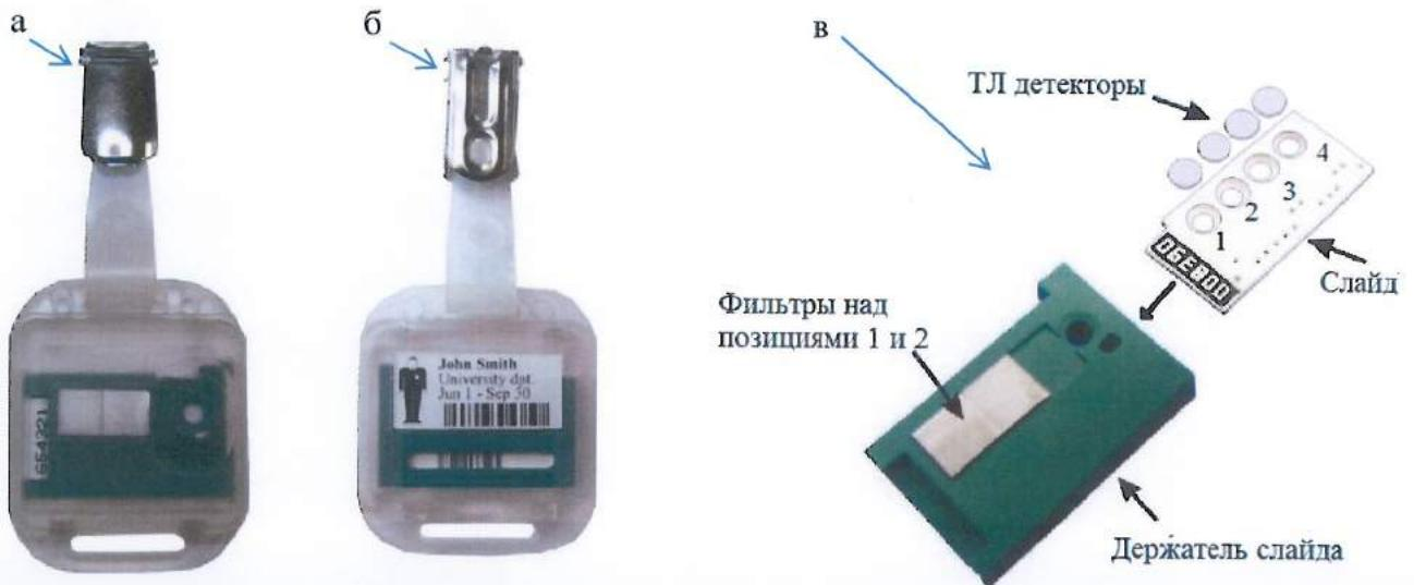
Рисунок 1 - Стандартный ТЛ дозиметр из состава комплекса ТЛД RADOS:
